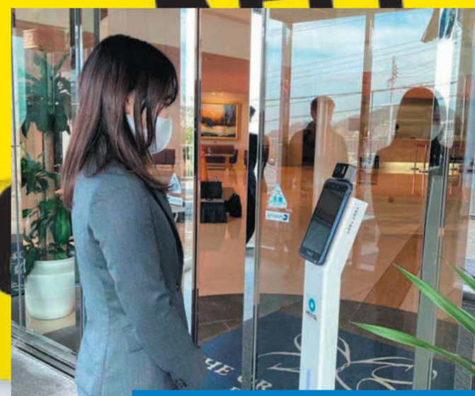
±0.1度の精度で温度測定 「HESTAセキュリティゲート」
